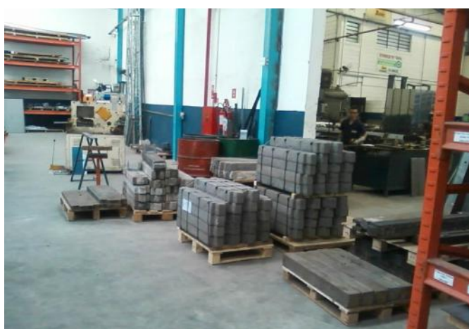
Figura 17-Armazenagem de materiais inadequados Fonte: Arquivo próprio
